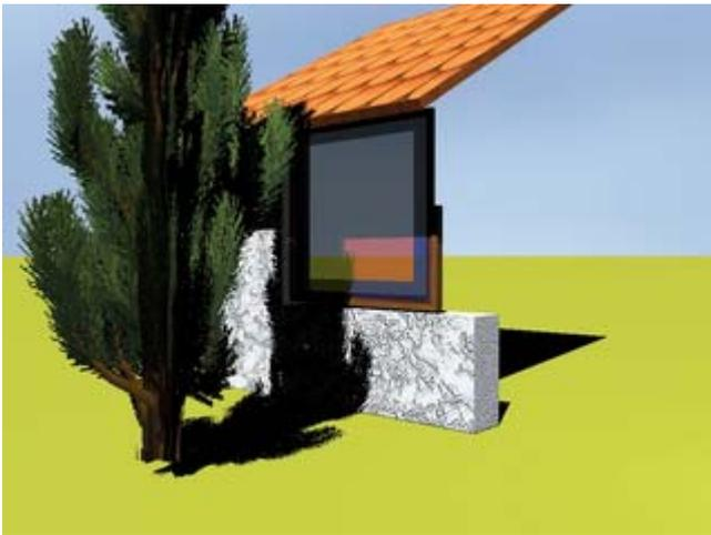
**Abbildung 1: Beispiel einer besonderen Temperaturbelastung durch Schlagschatten**
